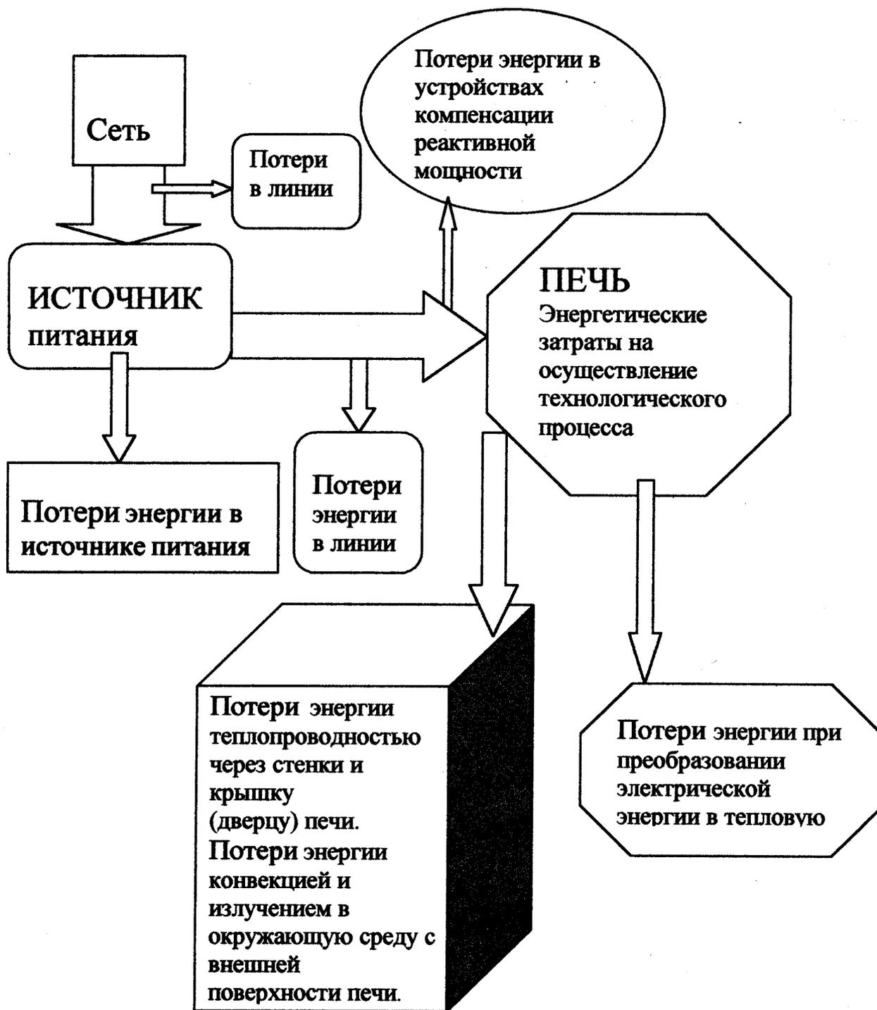
Рис. 3.5. Энергетическая диаграмма электротермической печи
