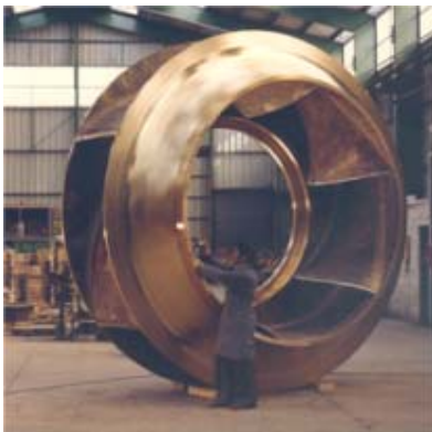
НБСК рабочее колесо 4м пресная вода АЭС St Alban 1300 МВт, Франция
