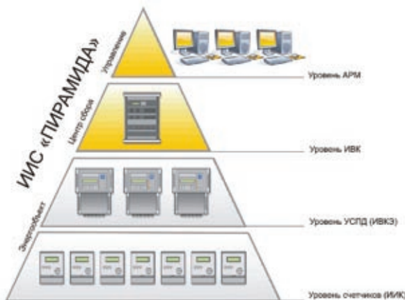
Рис. 1. Схема ИИС «Пирамида».
